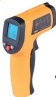
Este termómetro con infrarrojos trabaja en un rango de -50 °C a 330 °C por lo que resulta especialmente recomendable para objetos sometidos a altas temperaturas. Se trata de un instrumento de alta precisión, de alta resolución y baja reproducibilidad, dotado con pantalla LCD con luz de fondo, lo que permite la obtención de datos de forma clara. Es un termómetro de bajo consumo de energía, portátil y cómodo de manejar pero también seguro, debido a la resistencia de su material de aislamiento.
