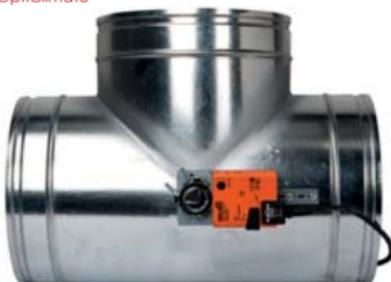
La válvula de 3 vías se utiliza en el sistema Dual Room. Con el sistema Dual Room, es posible refrigerar 2 recintos con 1 mismo OptiClimate. Si se va a usar este sistema, es preciso adquirir un sensor de temperatura adicional. Al utilizar la válvula de 3 vías, la función de calefacción y deshumidificación nocturnas se cancela.
