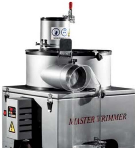
Lleva un sistema de recuperación de hojas bajo las cuchillas con una bolsa de rejilla muy resistente. Podremos regular en altura las cuchillas para ajustar la medida del corte de las hojas.
